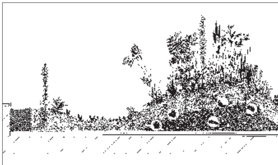
Hügelbereiche abwechselnd mit tieferen Substratschichten führen zu einem vielfältigen Bewuchs mit unterschiedlichen Standortbedingungen.
